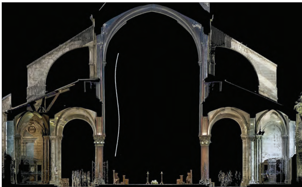
Figure 25. Paris, abbatale de Saint-Germain-des-Prés, analyse laser, 2012, coupe 4. Image Andrew Tallon.
