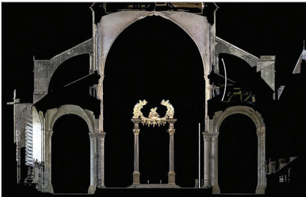
Figure 7. Sens, cathédrale, analyse laser, 2011, coupe 3. Image Andrew Tallon.
