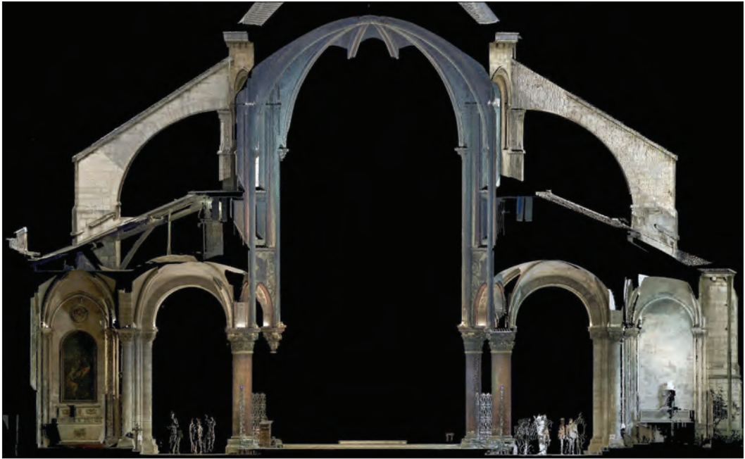
Figure 24. Paris, abbatale de Saint-Germain-des-Prés, analyse laser, 2012, coupe 3. Image Andrew Tallon.
