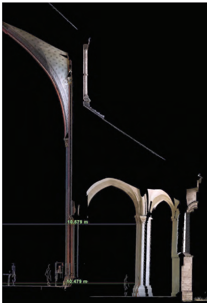
Figure 31. Paris, Saint-Martin-des-Champs, prieurale, analyse laser, 2011, coupe sur le chevet. Images Andrew Tallon.
