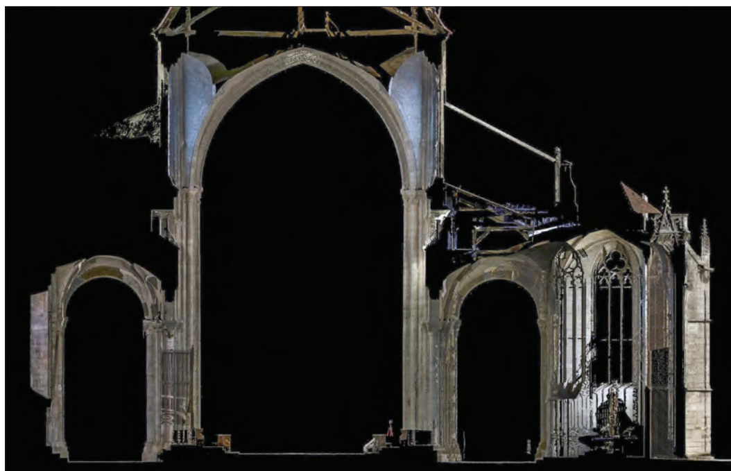
Figure 9. Sens, cathédrale, analyse laser, 2011, coupe 6. Image Andrew Tallon.
