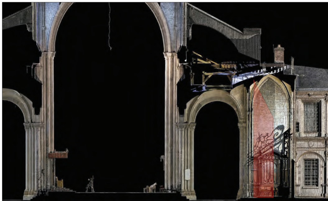
Figure 18. Sens, cathédrale, analyse laser, 2011, coupe 4 (détail). Image Andrew Tallon.
