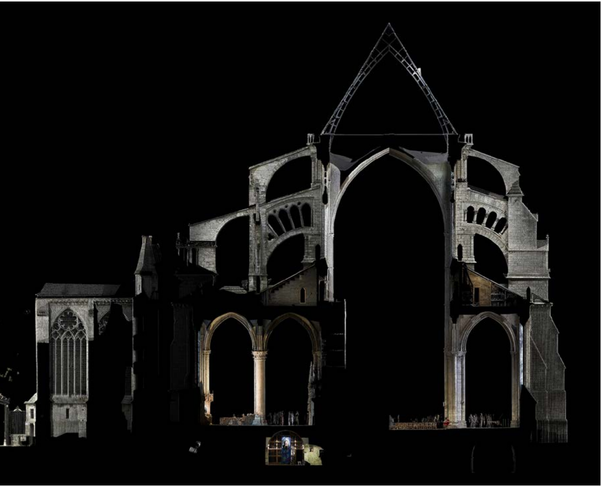
Fig. 5 : Chartres, cathédrale. Coupe transversale comparative à travers le chœur (à gauche) et la nef (à droite). Relevé laser, juin 2011. © A. Tallon.
