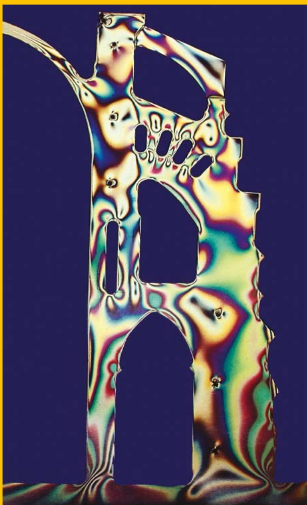
Fig. 10 : Chartres, cathédrale. Maquette photoélastique de la nef. Robert Mark, Experiments in Gothic Structure , Cambridge, Mass., 1982, pl. 2.
