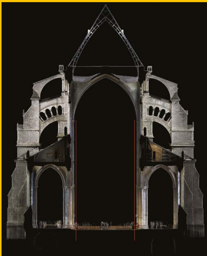
Fig. 13 : Chartres, cathédrale. Coupe transversale de la nef avec lignes verticales indiquant l'aplomb. Relevé laser, juin 2011. © A. Tallon.
