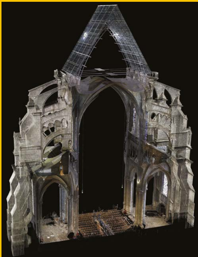
Fig. 12 : Chartres, cathédrale. Vue axonométrique d'une travée complète de la nef. Relevé laser, juin 2011. © A. Tallon.
