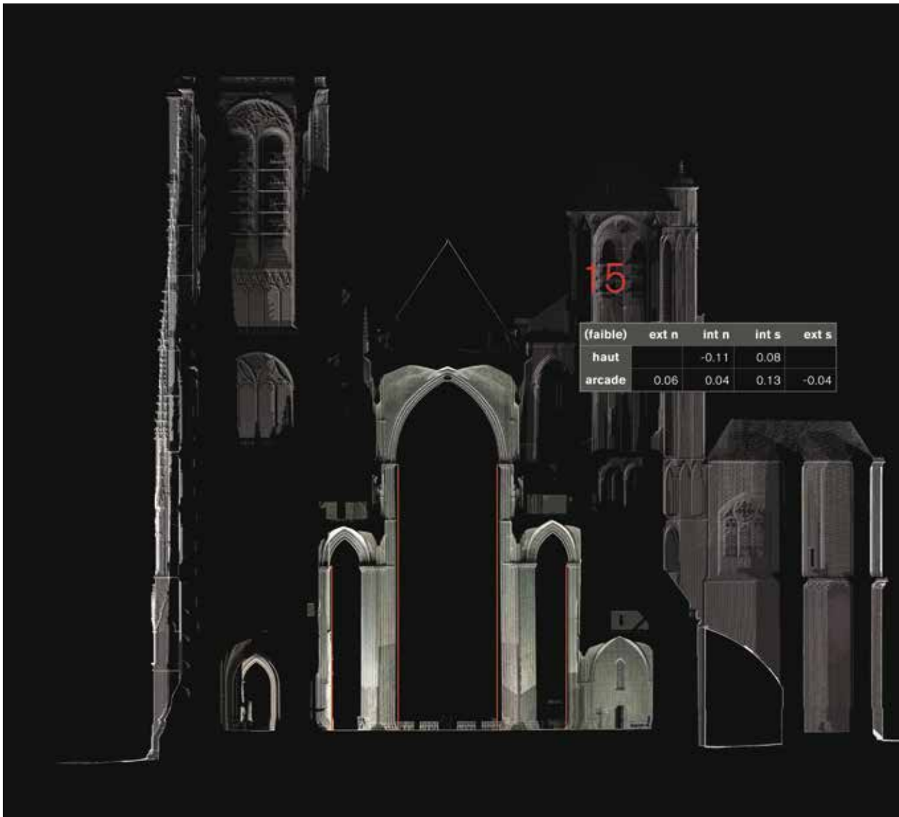
Fig. 17 - Bourges, cathédrale, relevé laser, coupe transversale des supports orientaux des tours de la façade (n° 15).
