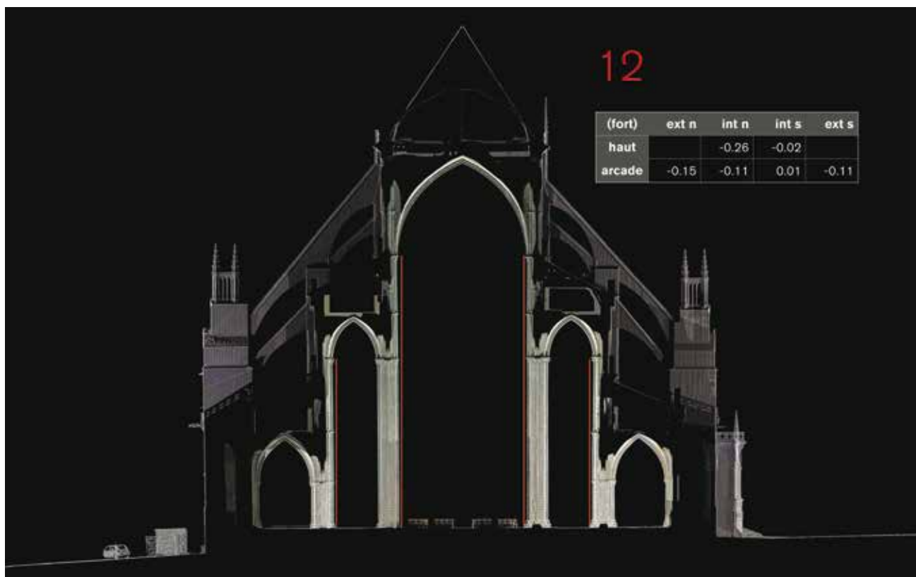
Fig. 15 - Bourges, cathédrale, relevé laser, coupe transversale sur la nef (n° 12).
