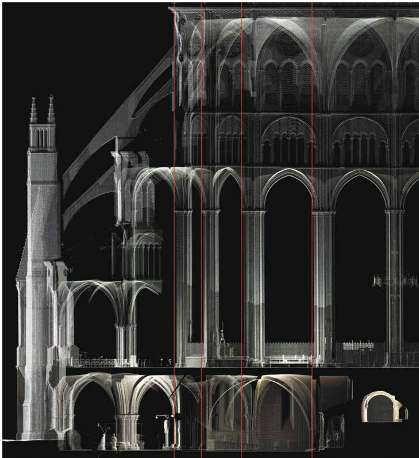
Fig. 5 - Bourges, cathédrale, relevé laser, coupe longitudinale sur le chevet, côté sud.
