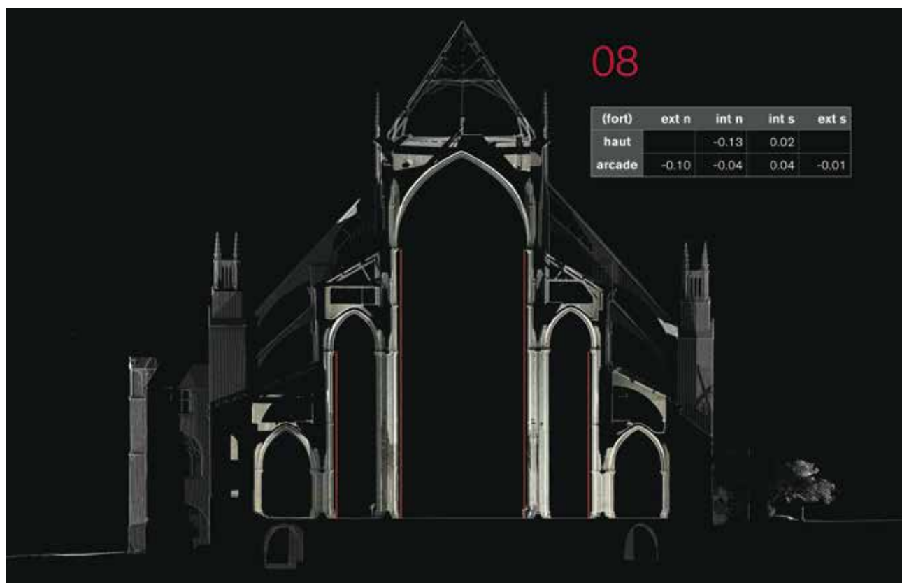
Fig. 11 - Bourges, cathédrale, relevé laser, coupe transversale (n° 8).
