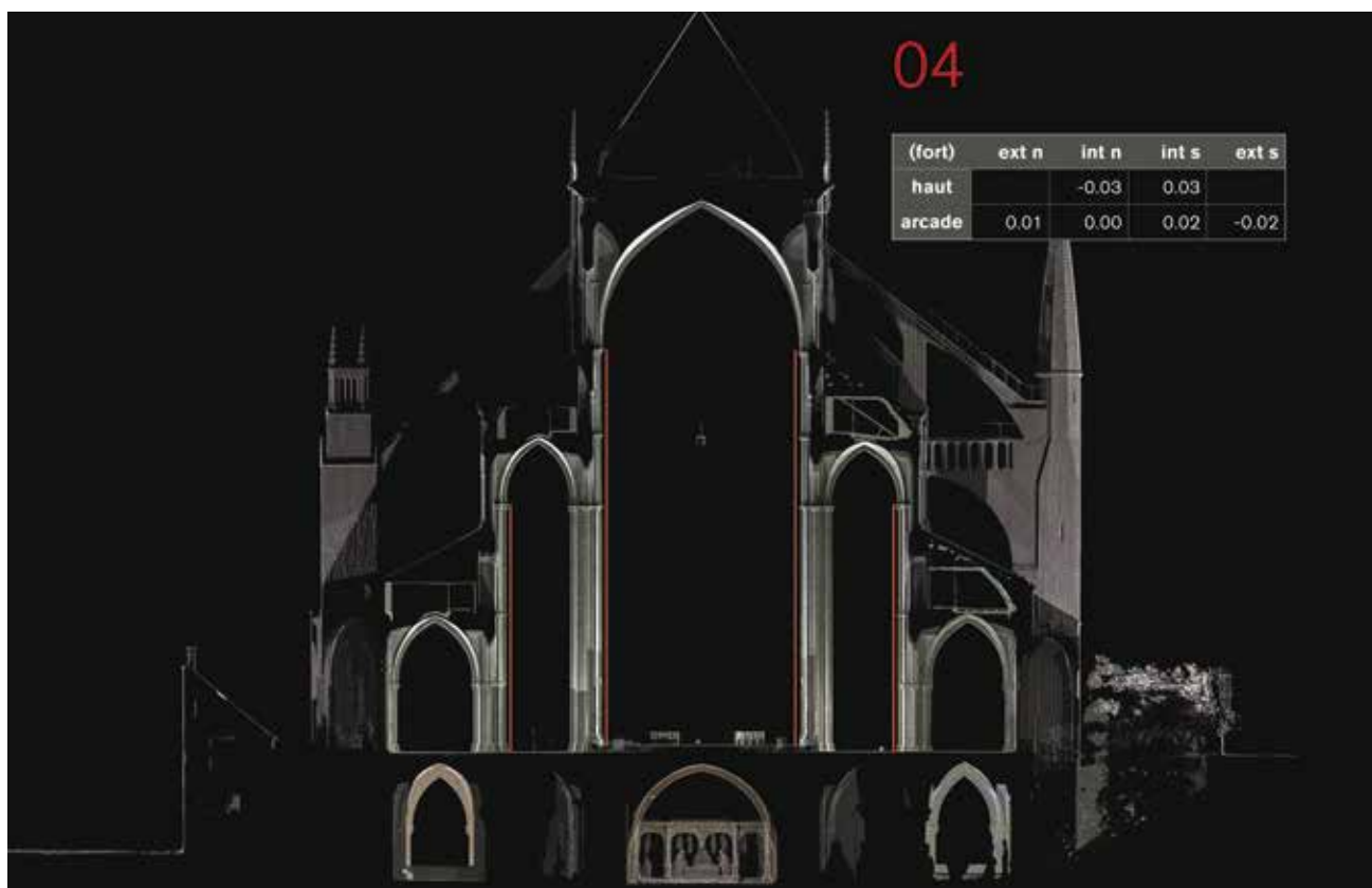
Fig. 7 - Bourges, cathédrale, relevé laser, coupe transversale sur le chevet (n° 4).
