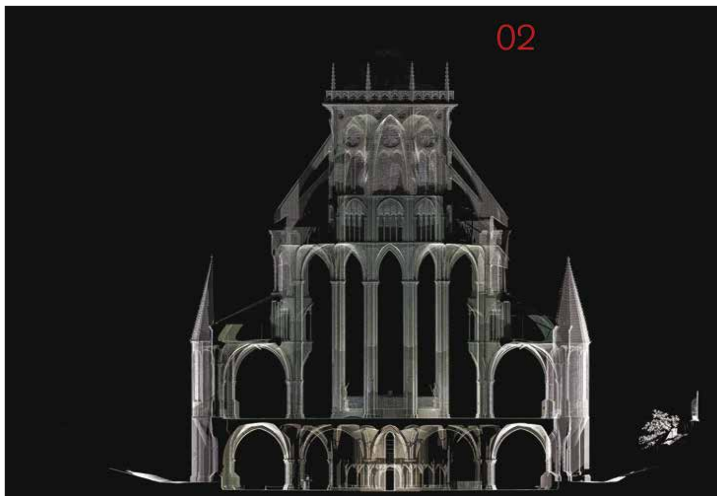
Fig. 3 - Bourges, cathédrale, relevé laser, coupe transversale sur le déambulatoire (n° 2).
