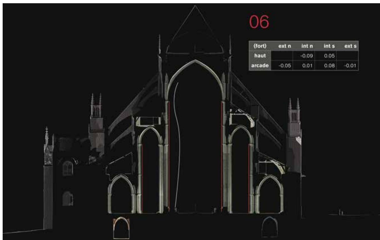
Fig. 10 - Bourges, cathédrale, relevé laser, coupe transversale sur le chœur (n° 6).
