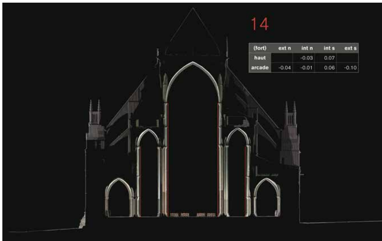
Fig. 16 - Bourges, cathédrale, relevé laser, coupe transversale sur la nef (n° 14).
