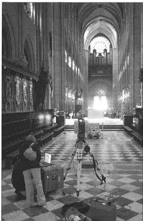
Fig. 2. Paris, cathédrale Notre-Dame, Leica Geosystems HDS 3000 en fonctionnement dans le chœur, juin 2006. Cl. A. J. Tallon.
